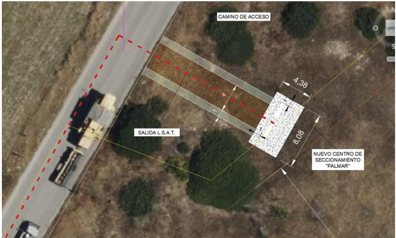
Cambio de trazado de la LSMT a la salida del CS. En amarillo, el antiguo y el rojo discontinuo, el nuevo.
